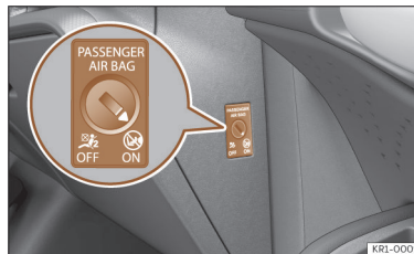
Joonis 27 Lüliti esiistmel istuva kaassõitja esiturvapadja sisse- ja väljalülitamiseks
