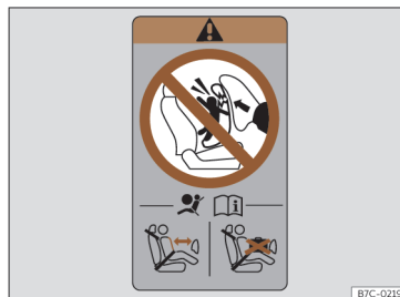
Joonis 36 Turvapadjaja hoiatussilt: kaassõitjapoolse esiukse raamil (B-piilaril)
