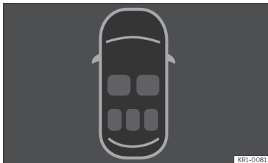
Joonis 18 Näidikuplokis: turvavööde oleku näit
