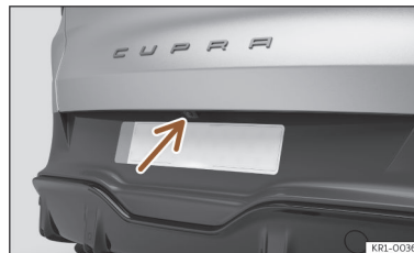
Joonis 114 Tagakaitserauas: tahavaatekaamera asukoht
