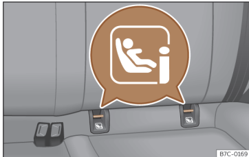
Joonis 37 Tagaistmel: ISOFIX- või i-Size-kinnitusaasade asukoht
