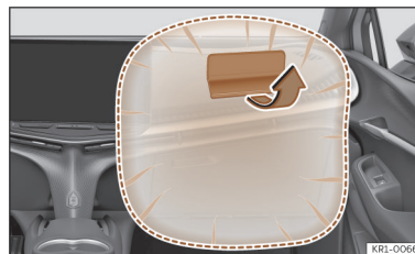
Joonis 26 Esiistmel istuva kaassõitja esiturvapadi armatuurlaas
