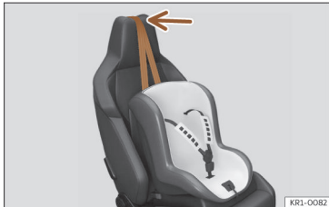
Joonis 43 Kaassõitja esiiste: ülemise kinnitusrihma paigutamine ja kinnitamine vastavalt rihma tüübile
