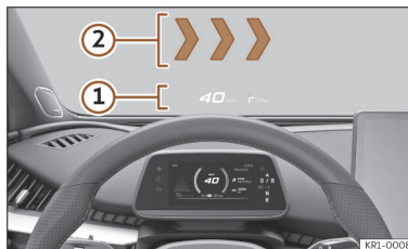
Joonis 5 Juhi vaateväljas: esiklaasinäidiku lähitsoon ① ja liitreaalsuse tsoon ②
