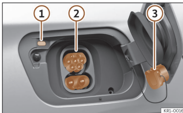
Joonis 58 Taga paremal küljel aku laadimispea luugi taga
