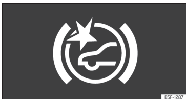
Joonis 125 Näidikuploki ekraanil: kokkupõrke hoiatuse näit
