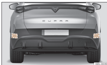
Joonis 112 Auto tagantvaade: radarandurite asukohad
