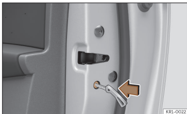
Joonis 75 Avariilukk ukse käsitsi lukustamiseks
