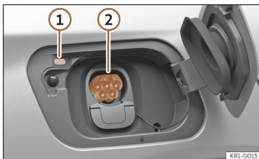
Joonis 56 Taga paremal küljel aku laadimispesa luugi taga: laadimispesa
