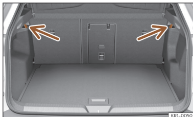
Joonis 171 Pagasiruumis: kotikonsud
