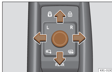
Joonis 98 Detail juhiuksel: küljepeeglite reguleaator
