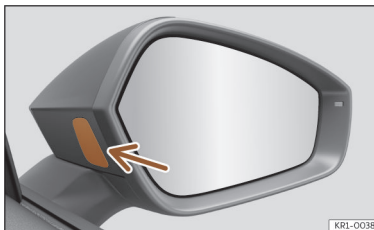
Joonis 134 Rajavahetuse abisüsteemi hoiatustuli
