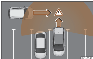
Joonis 151 Hoiatussüsteemi skemaatiline kujutis: jälgitav piirkond auto taga parkimiskohalt välja tagurdamisel
