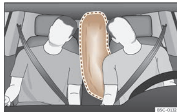
Joonis 32 Täielikult avanenud kesksturvapadi (täitumispikkond)
