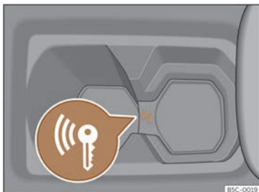
Joonis 112 Keskkonsoolis: hädakäivituseks mõeldud võtmepesa
