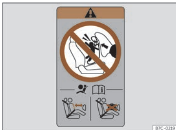
Joonis 40 Turvapadja hoiatussilt: kaassõitjapoolse esiukse raamil (B-piilaril)
