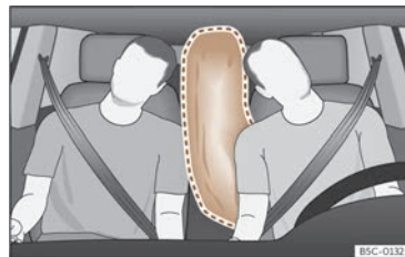
Joonis 32 Täielikult avanenud kesksturvapadi (täitumispikkond)
