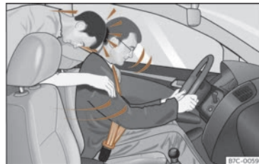
Joonis 22 Turvavööta tagaistujad võivad suure hooga ette vastu turvavööga kinnitatud autojuhti paiskuda.
