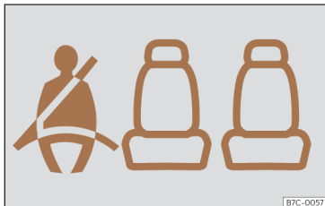
Joonis 20 Näidikuploki: tagaistme turvavööde oleku näit
