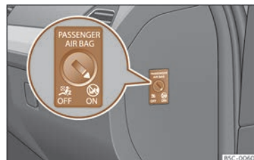
Joonis 29 Lülitati esiistmel istuva kaassõitja esiturvapadja sisse- ja väljalülitamiseks
