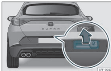
Joonis 81 Tagaluuk: avamine väljastpoolt
