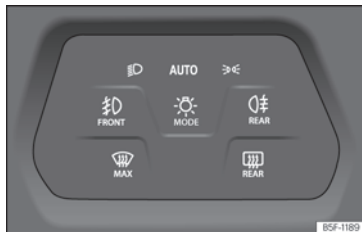
Joonis 89 Armatuurlaud: tulede lülid
