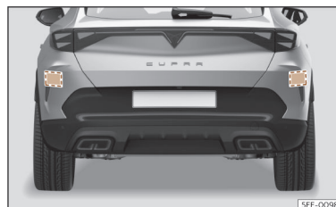
Joonis 131 Auto tagantvaade: radarandurite asukohad
