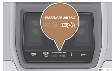
Joonis 28 Laekonsoolis: esiistmel istuva kaassõitja välja lülitatud esiturvapadja hoiatustuli
