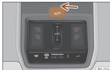
Joonis 50 Laekonsoolis: kõneteenuste lülitid
