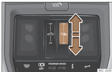
Joonis 90 Laekonsoolis: päikesevarju puutelüliti
