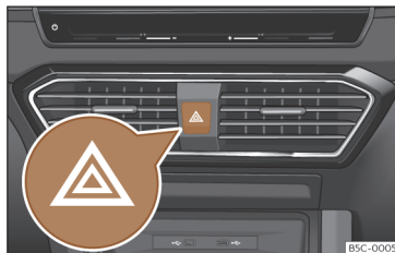
Joonis 49 Armatuurlaual: ohutulede lüliti
