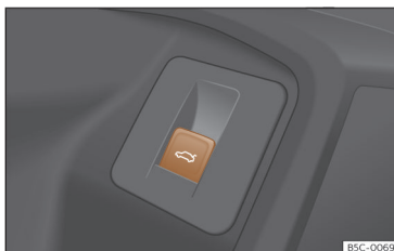
Joonis 83 Juhiuksel: tagaluugi avamis- ja sulgemislüliti
