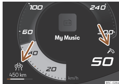
Joonis 136 Säästliku sõidu abisüsteemi näit (skemaatiline kujutis)
