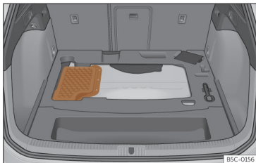
Joonis 227 Pistikhübridid (PHEV): aku asukoht pagasiruumis
