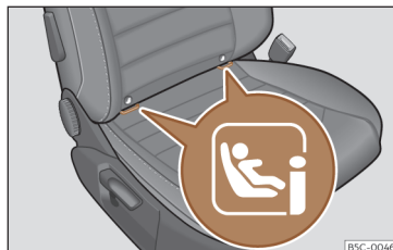
Joonis 40 Kaassõitja esiistmel: i-Size-kinnitusaasade asukoht
