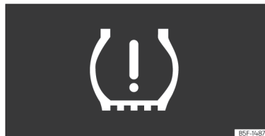
Joonis 240 Näidikuplokis: madala rehvirõhu hoiatus
