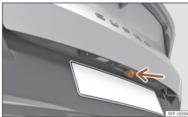
Joonis 133 Tagaluugi käepidemel: tahavaatekaamera asukoht
