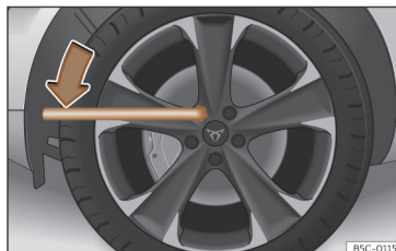
Joonis 237 Ratta vahetamine: rattapoltide lahtikeeramine
