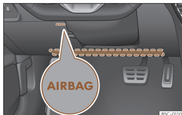
Joonis 34 Juhikohal: põlveturvapadja asukoht
