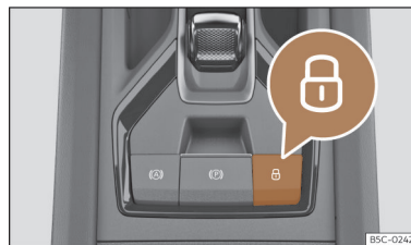
Joonis 77 Keskkonsoolis: kesklukustuslüliti
