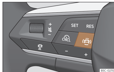
Joonis 127 Multifunktsionaalse rooli vasakul poolel: juhiabisüsteemide lüliti (sõltuvalt mudelivariatsioonist)
