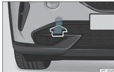
Joonis 43 Esikaitseraua paremal pool: eemaldatav kate
