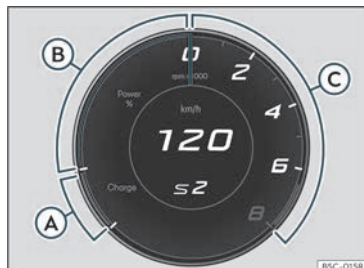
Joonis 57 Digitaalne näidikuplokk: energiamõõdik (Cupra vaade)
