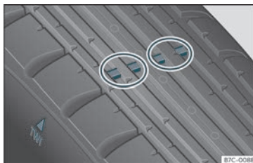
Joonis 213 Rehvi turvisemuster: turvis kulumisindikaatorid
