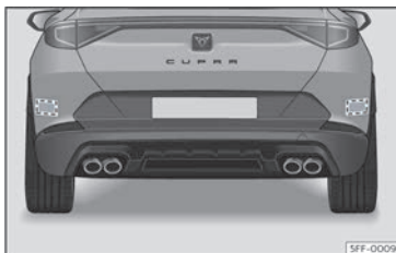
Joonis 148 Auto tagantvaade: radarandurite asukohad
