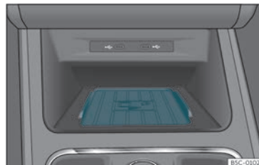
Joonis 135 Keskkonsoolis: alus mobiiltelefoni ühendamiseks ja laadimiseks
