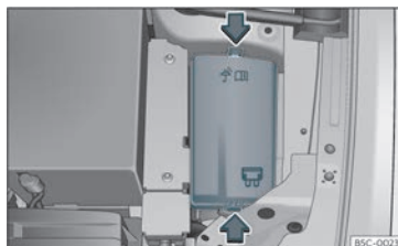
Joonis 48 Mootoriruumis: kaitsmekarbi kate
