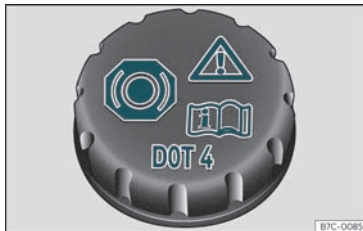
Joonis 208 Mootoriruumis: pidurivedeliku paagi kork
