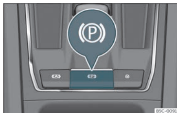
Joonis 172 Keskkonsooli alaosas: elektroonilise seisupiduri lüliti
