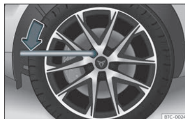
Joonis 37 Ratta vahetamine: rattapoldide lahti- keeramine
