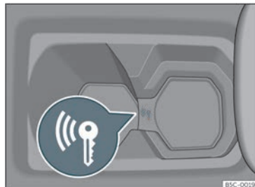
Joonis 139 Keskkonsoolis: hädaikäivituseks mõeldud võtmepesa
