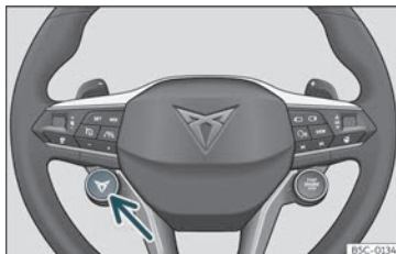
Joonis 144 Multifunktsionaalsel roolil*: sõiduprofiili valikulüliti
