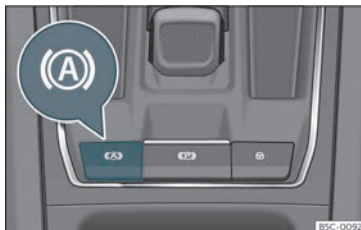
Joonis 173 Keskkonsooli alaosas: automaatse seisupiduri (Auto Hold) lüliti
