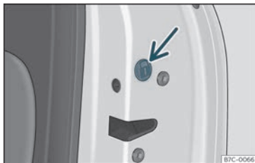
Joonis 79 Avariilukk ukse käsitsi lukustamiseks
