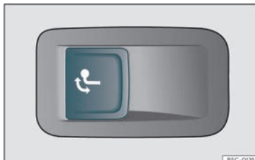
Joonis 185 Pagasiruumi vasakul küljel: veokonksu vabastusklahv
