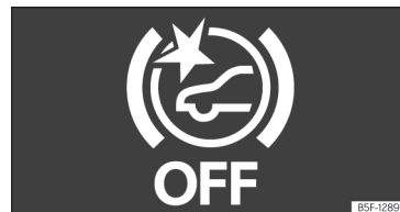
Joonis 155 Näidikuploki ekraanil: välja lülitatud esikokkupõrke vältimissüsteemi näit
