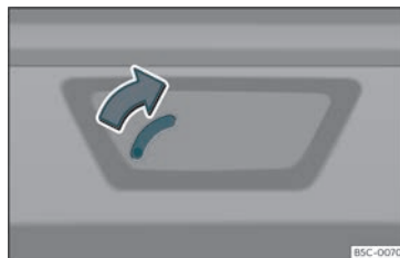
Joonis 85 Pagasiruumi detail: avariivajaja
