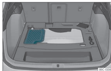
Joonis 211 Aku paigalduskoht pagasiruumis
