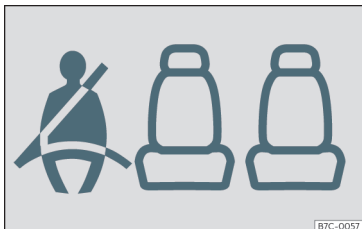
Joonis 5 Näidikuplokis: näitab, et tagaistme vasak koht on hõivatud ja vastav turvavöö on kinnitatud.
