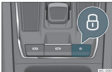
Joonis 75 Keskkonsoolis: kesklukustuslüliti
