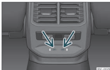
Joonis 137 Keskkonsooli tagaküljel: USB-laadimispesad
