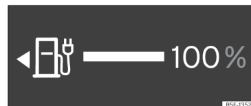
Joonis 58 Digitaalne näidikuplokk: aku laetuse taseme mõõdik
