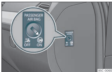
Joonis 15 Lüliti esiistmel istuva kaassõitja esiturvapadja sisse- ja väljalülitamiseks
