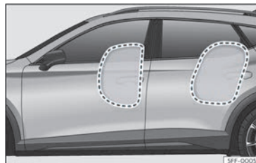
Joonis 22 Lõpuni täitunud külgturvapadjad auto vasakul küljel
