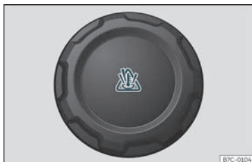
Joonis 207 Mootoriruumis: jahutusvedeliku paisupaagi kork
