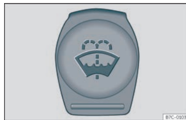
Joonis 209 Mootoriruumis: klaasipesuvedeliku paagi kork
