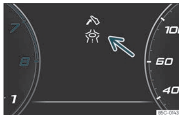
Joonis 55 Säästliku sõidu abisüsteemi näit (skeemaoline kujutis)
