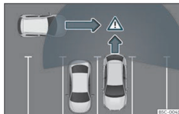
Joonis 169 Tagurdamisel tuvastatud küljelt läheneva liikluse hoiatussüsteemi skemaatiline kujutis: jälgitav piirkond auto taga parkimiskohalt välja tagurdamisel
