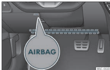
Joonis 17 Juhikohal: põlveturvapadja asukoht
