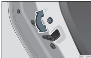
Joonis 80 Lapselukk vasakpoolsel tagauksel
