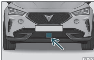
Joonis 145 Esikaitserauas: radarandur
