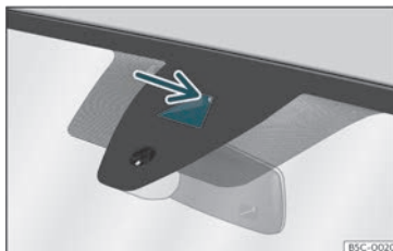
Joonis 147 Esiklaasil: sõiduraja hoidja kaamera vaateaken
