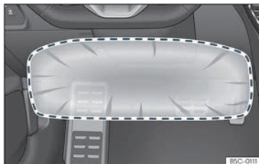
Joonis 18 Juhikohal: põlveturvapadja täitumipiirkond
