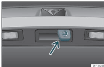
Joonis 150 Tagaluugi käepidemes: tahavaatekaamera asukoht
