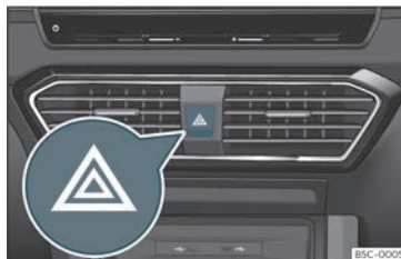
Joonis 91 Armatuurilaua: ohutulede lüliti
