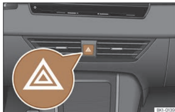
Joonis 60 Armatuurlaual: ohutulede lüliti
