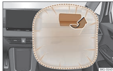
Joonis 42 Esiistmel istuva kaassõitja esiturvapadi armatuurlaas
