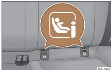
Joonis 52 Tagaistmel: ISOFIX- või i-Size-kinnitusaasade asukoht
