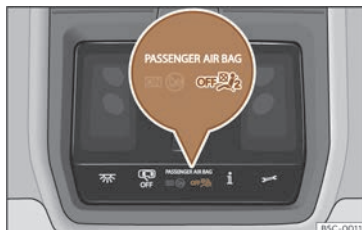
Joonis 44 Laekonsoolis: esiistmel istuva kaassõitja välja lülitatud esiturvapadja hoiatustuli
