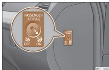
Joonis 43 Lülitati esiistmel istuva kaassõitja esiturvapadja sisse- ja väljalülitamiseks
