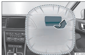
Joonis 14 Esiistmel istuva kaassõitja esiturvapadi armatuurlaudas
