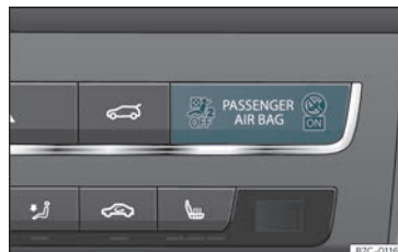
Joonis 16 Armatuurlaul: esiistmel istuva kaassõitja sisse või välja lülitatud esiturvapadja hoiatustuli
