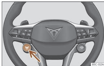
Joonis 97 Multifunktsionaalsel roolil: sõiduprofiili valikulüliti
