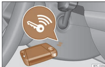
Joonis 90 Roolisamba paremal küljel: kontaktpind hädaikäivituseks
