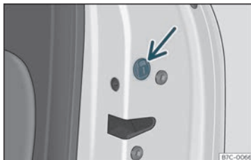
Joonis 80 Avariilukk ukse käsitsi lukustamiseks
