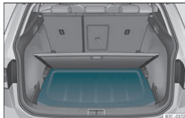
Joonis 113 Pagasiruumis: pagasiruumi kate hoiulepanek
