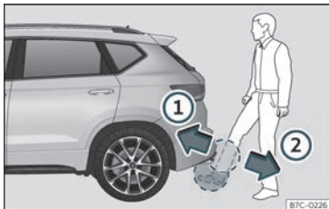
Joonis 85 Anduritega juhitava avamis- ja sulgemisfunktsiooniga (Easy Open) tagaluuk
