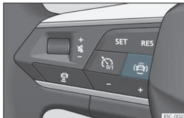
Joonis 64 Multifunktsionaalse rooli vasak pool: juhiabisüsteemide lüliti (sõltuvalt mudeliversioonist)
