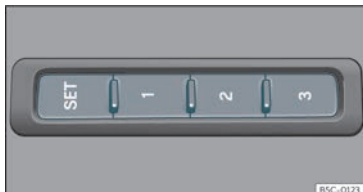
Joonis 106 Juhiistme välisküljel: asendimälu lülid
