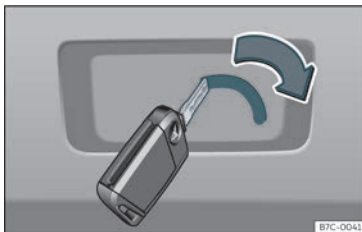
Joonis 87 Pagasiruumi detail: avariivajaja kasutamine
