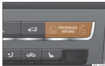
Joonis 26 Armatuurlaul: esiistmel istuva kaassõitja välja lülitatud esiturvapadja hoiatustuli keskkonsoolis
