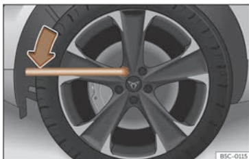
Joonis 209 Ratta vahetamine: rattapoltide lahtikeeramine
