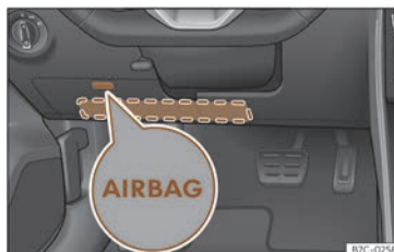
Joonis 30 Juhikohal: põlveturvapadja asukoht
