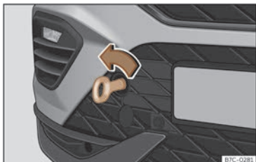
Joonis 184 Esikaitseraua paremal poolel: sisse keeratud pukseerimisaas
