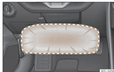
Joonis 31 Juhikohal: põlveturvapadja täitumispirkond
