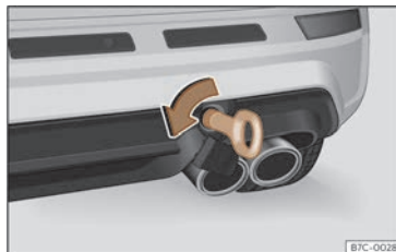
Joonis 186 Tagakaitseraua paremal poolel: sisse keeratud pukseerimisaas
