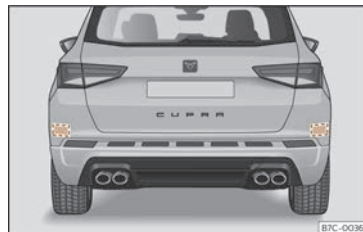
Joonis 104 Auto tagantvaade: radarandurite asukohad
