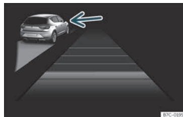
Joonis 163 Näidikuploki ekraanil: isekohanduv kiirushoidik töötab, vasakul sõidurajal on tuvastatud sõiduk
