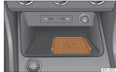
Joonis 160 Keskkonsoolis: alus mobiiltelefoni ühendamiseks ja laadimiseks
