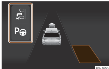
Joonis 135 Näidikuploki ekraanil: iseparkimissüsteemi näit koos vähendatud näiduga
