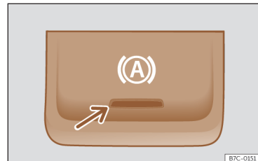
Joonis 128 Keskkonsooli alumises osas: automaatse seisupiduri (Auto Hold) lüliti
