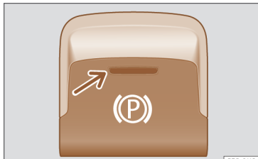
Joonis 127 Keskkonsooli alaosas: elektroonilise seisupiduri lüliti
