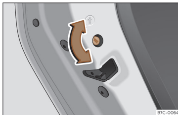
Joonis 53 Lapselukk vasakpoolsel tagauksel
