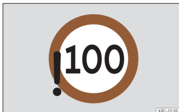
Joonis 7 Näidikuploki ekraanil: süsteem on tuvastanud piirkiruse ületamise (illustraatiivne kujutis)
