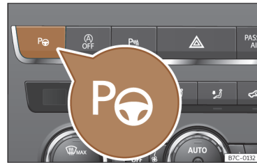
Joonis 134 Keskkonsooli ülalosas: iseparkimissüsteemi sisse- ja väljalülituslüliti
