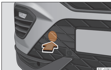
Joonis 187 Esikaitseraua paremal poolel: eemaldatav kate
