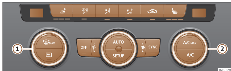
Joonis 86 Keskkonsoolis: automaatse kliimaseadme Climatronic juhtpaneel
