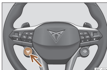
Joonis 97 Multifunktsionaalsel roolil: sõiduprofiili valikulüliti
