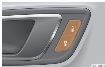
Joonis 49 Juhiuksel: kesklukustuslüliti
