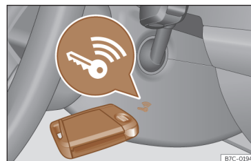
Joonis 90 Roolisamba paremal küljel: kontaktpind hädakäivituseks
