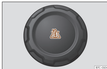
Joonis 198 Kapotialuses tehnooruumis: jahutusvedeliku paisupaagi kork
