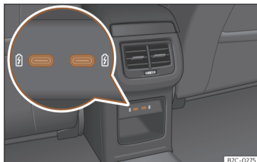
Joonis 154 Keskkonsooli tagaküljel: USB-laadimispesad
