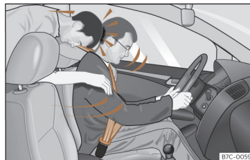
Joonis 18 Turvavööta tagaistujad võivad suure hooga ette vastu turvavööga kinnitatud autojuhti paiskuda.
