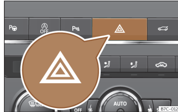
Joonis 40 Armatuurlaual: ohutulede lüliti
