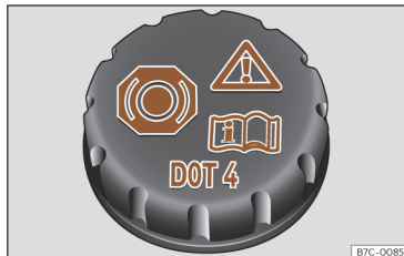
Joonis 199 Kapotialuses tehnoariumis: pidurivedeliku paagi kork
