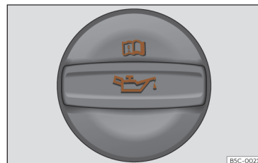
Joonis 204 Mootoriõli täiteava kork mootoriruumis
