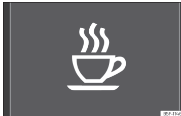
Joonis 5 Näidikuploki ekraanil: juhi väsimuse tuvastussüsteemi sümbol
