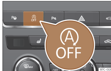
Joonis 91 Keskkonsoolis: start-stopp-süsteemi lüliti
