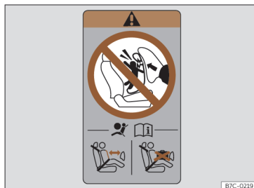
Joonis 34 Turvapadja hoiatussilt: kaassõitjapoolse esikuks raamil (B-piilaril)
